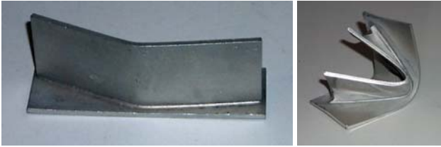
figuur 2 Vlamgesoldeerde verbinding in aluminium (stompe verbinding in aluminium - EN AW-1050). Na het solderen (links) en na het vervormen van het product (rechts)
