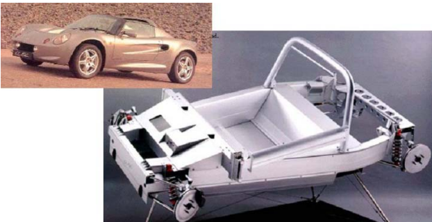
figuur 3 Lotus Elise: verlijmd aluminium frame
